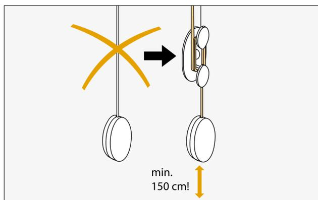
Bei schnurbedienten Anlagen müssen grundsätzlich Schnurwickler montiert werden. Die Montage des Schnurwicklers muss so erfolgen, dass die Unterkante der Schnurquaste mindestens 1,5 m vom Boden entfernt ist.
